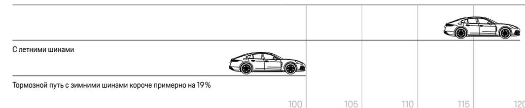
Пример: тормозной путь в % (измерен при использовании шин по спецификации Porsche). Оптимизация тормозного пути благодаря зимним шинам Porsche. Абсолютные значения могут варьироваться.
